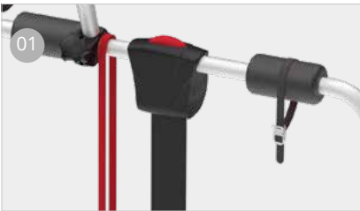
Active - Cinghia di tensionamento Rende semplice e immediato l'accesso al gavone
